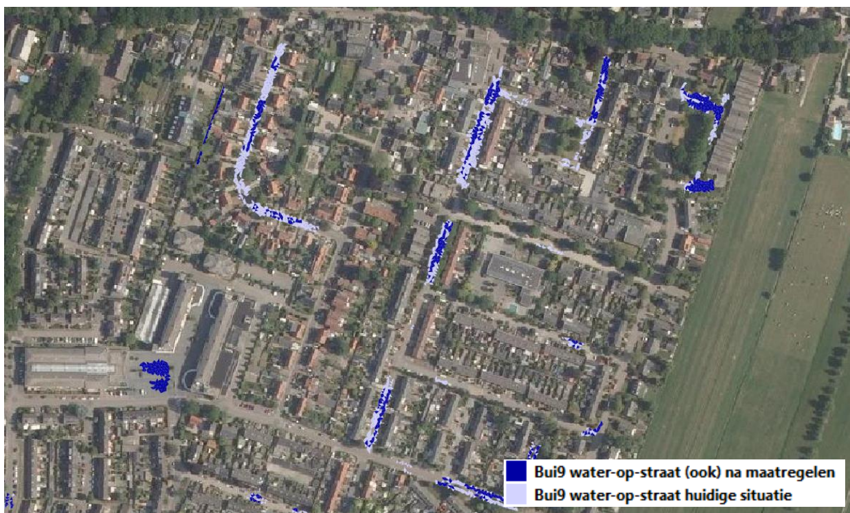
Figuur 68 – Effect van aanleg hemelwaterriolering Maartensdijk bij Bui 9: water-op-sstraat voor en na de maatregelen.
