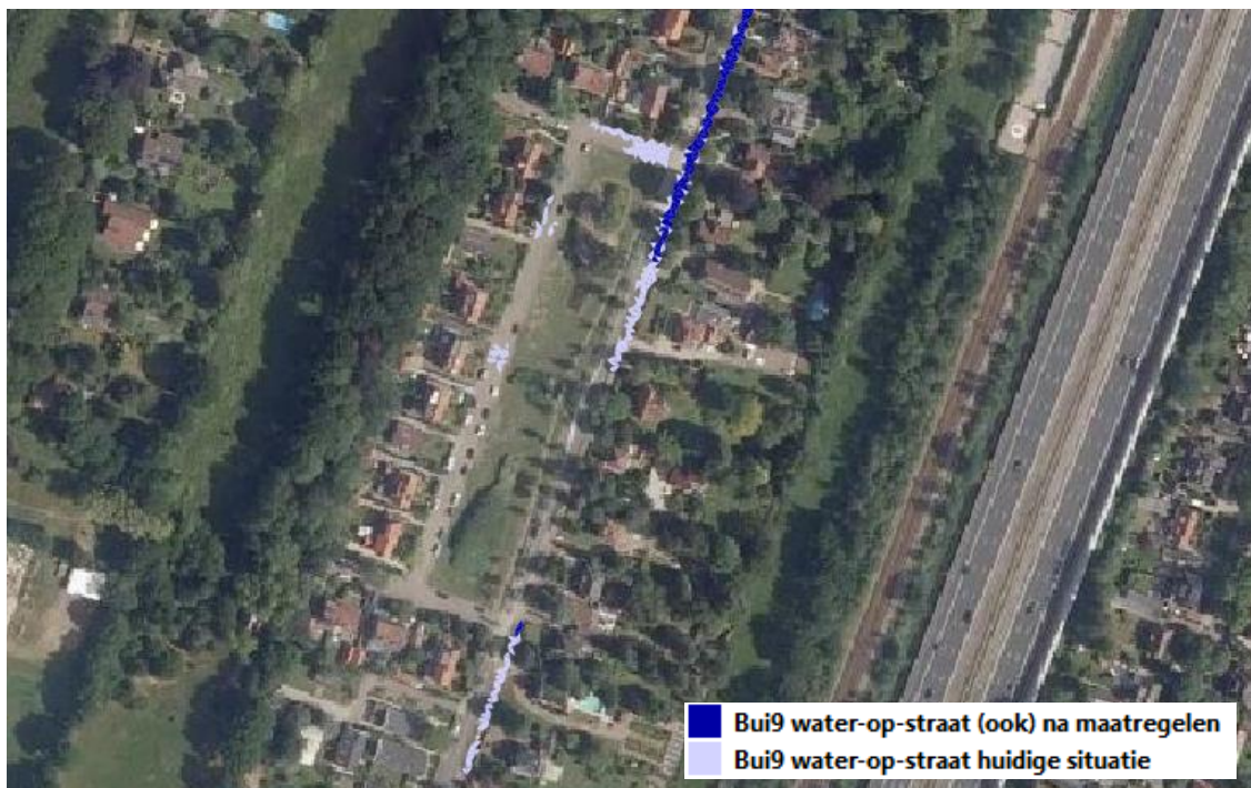
Figuur 65 – Effect van aanleg hemelwaterriolering Tolakkerweg-Noord bij Bui 9: water-op-sstraat voor en na de maatregelen.
